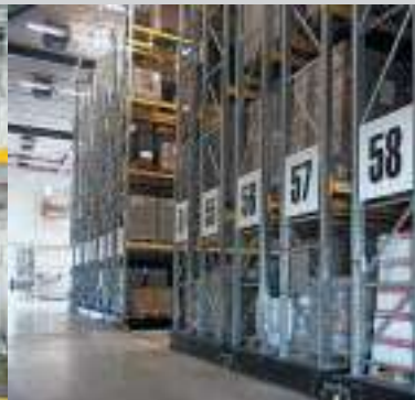
Mobil állványok raklapos áru és szállanyag tárolására
