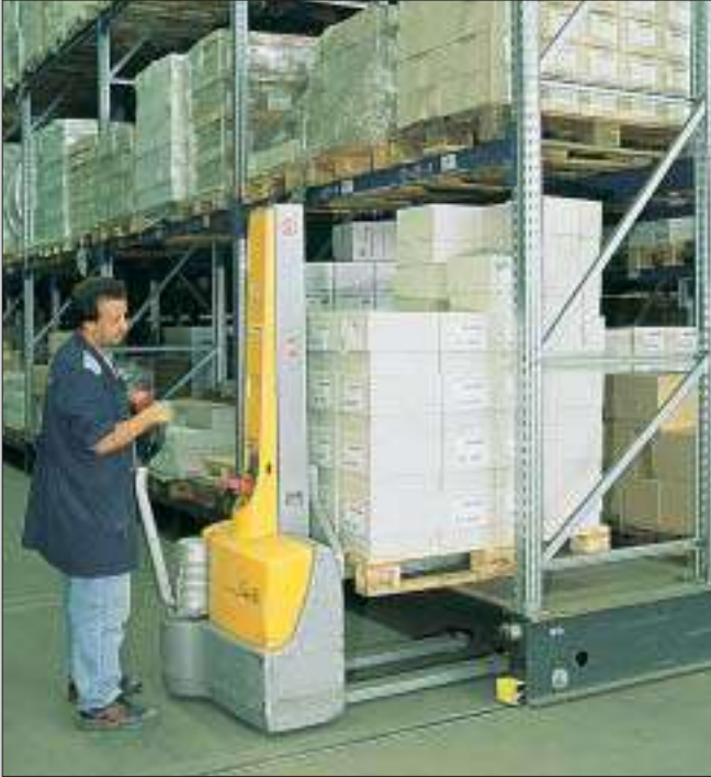
A raklapok gyalogkíséretű elektromos targoncával is kivehetők.
