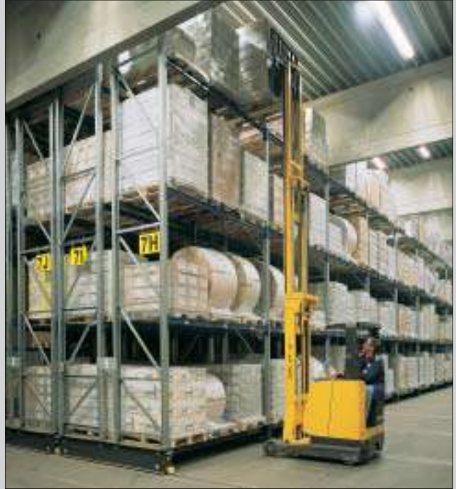
A mobil állványokhoz rendszerint tolóoszlopos targoncát használnak.
