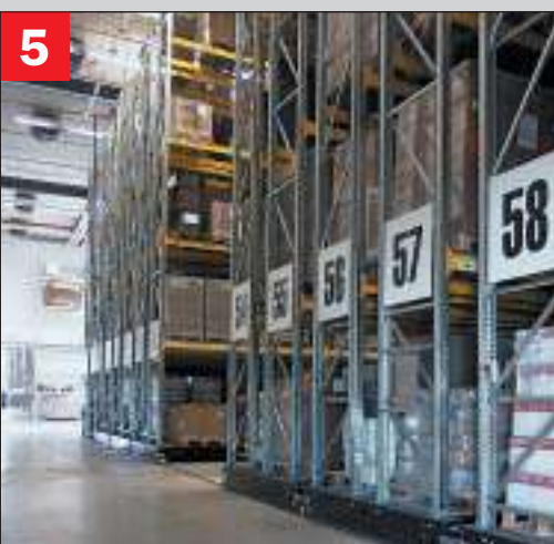
Mobil állványok raklapos áru és szálanyag tárolására
