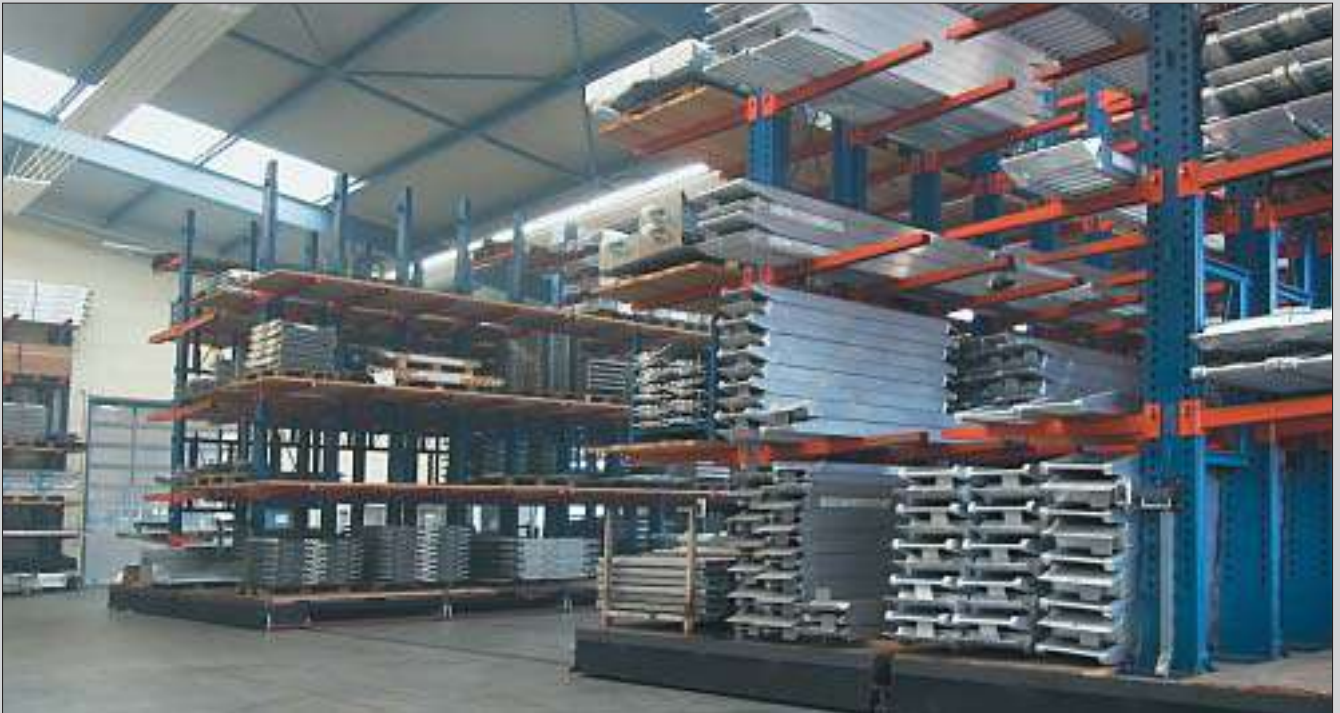
Mobil állványrendszer karos állványokkal.
