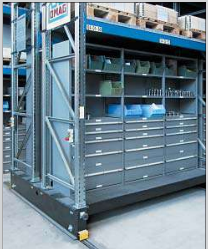
Mobil állványok szerszám- és alkatrészraktárban.
