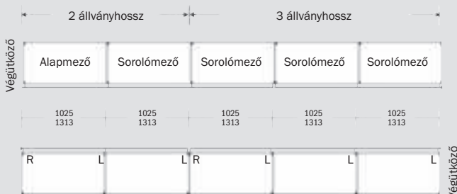
A bal és jobb konzolok eloszlása az állványsorokban (felülnézet)
