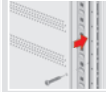
Rögzítés a lábhoz csavarokkal
