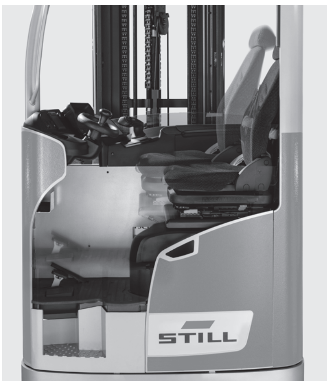
Position de conduite ergonomique grâce au siège proportionnel et un large espace pour les pieds
