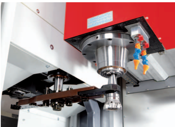
Az ISO 40 DIN 69871 / ISO 7388/2 szabvány szerinti B típusnak megfelelő nagy teljesítményű főorsó. Opció: ISO 40 DIN 69871 / DIN 69872, BT40, HSK-A63 (csak motororsókhoz).
