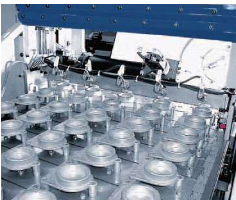
Láncos adagoló a nyersdarabok gyors ütemű tájolt adagolásához.
