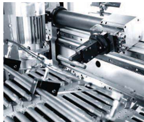
Láncos adagoló prizmatikus tartókkal különböző tengelyszerű előgyártmányokhoz.
