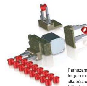
Tengelyek teljesen automatikus adagolása. Beadagolás láncos adagolóval, kiadagolás kész munkadarab elkapó berendezéssel.
