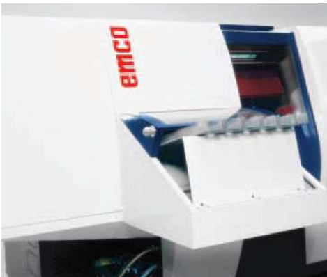
Többcsatornás adagoló vályú tengelyszimmetrikus nyersdarabokhoz. Mindegyik vályúnál egy szenzor ellenőrzi a nyersdarabok rendelkezésre állását.
