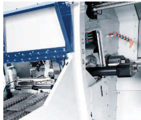
Tengelyek teljesen automatikus adagolása. Beadagolás láncos adagolóval, kiadagolás kész munkadarab elkapó berendezéssel.
