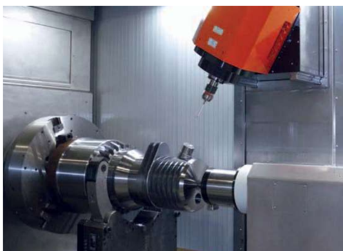
Munkadarab mérés: A teljes munkadarab-mérés a folyamatba integrált, ezáltal garantálva a nagy precízitást valamint a megmunkálás során végzett méréseket.
