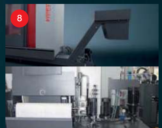
Forgácskihordó, papírszalagos szűrő, hűtővíz szivattyú
