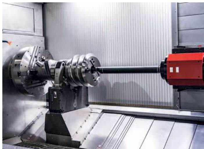
Fúrórúd: Rezgécscillapított fúrórúd 100 x 100 mm átmérővel a belső esztergáláshoz. Ehhez további 3 speciálisan méretezett szerszám áll rendelkezésre.
