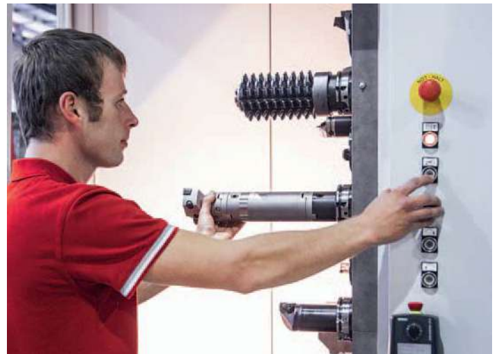
Ergonómikusan tölthető szerszámtár: legfeljebb 25 kg-os és 600 mm kinyúlású szerszámokkal.
