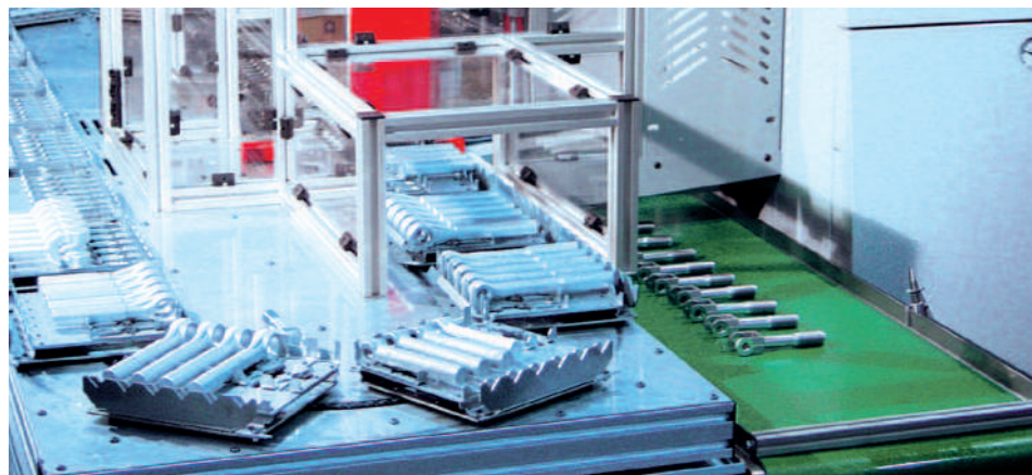
20-helyes palettás rendszer ügyfélspecifikus palettafeltétekhez
