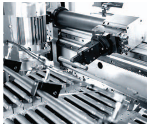
Ütemes szállító szalag prizmás megfogóval különböző módon előmunkált tengelyekhez.
