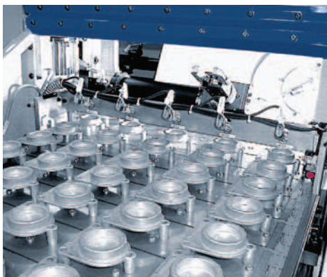
Nagy tároló kapacitású láncos szállítószalag tájolt elhelyezésű alakos előgyártmányok behelyezéséhez.
