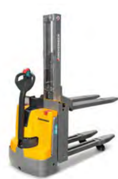
Elektromos gyalogkísérő targonca két rakodólap egyidejű kezelésére Típus EMD 115i/118 Max. emelési magasság 1520 mm Teherbírás max. 1800 kg
