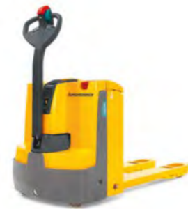
Elektromos gyalogkísérő emelőkocsi Típus EJE 116–120 Teherbírás max. 2000 kg
