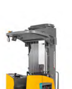
Tolóvillás targonca Típus ETR 230/235/340/345/335d Max. emelési magasság 11 354 mm Teherbírás max. 2000 kg
