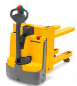
Elektromos gyalogkísérő emelőkocsi Típus EJE C20 Teherbírás max. 2000 kg
