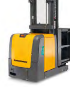
Elektromos vertikális kommissiózó targonca Típus EKS 210/312* Kommissiózási magasság max. 11 345 mm Teherbírás max. 1200 kg
