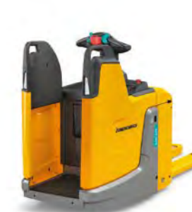
Elektromos vezetőállásos emelőkocsi Típus ERE 120/125/225 Teherbírás max. 2500 kg
