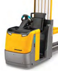
Elektromos horizontális kommissiózó targonca Típus ECD 320 Teherbírás max. 2000 kg
