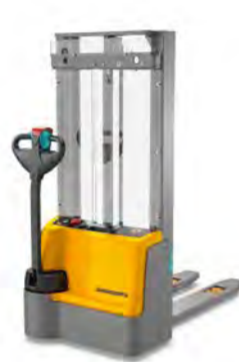
Elektromos gyalogkísérő targonca Típus EJC M10 ZT/M13 ZT Max. emelési magasság 3300 mm Teherbírás max. 1300 kg
