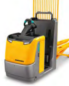
Elektromos horizontális kommissiózó targonca Típus ECE 310/320 Teherbírás max. 2000 kg Opcionális easyPILOT távvezérléssel
