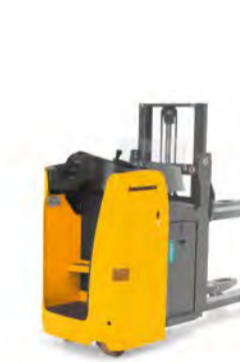
Elektromos vezetőállásos és oldaluléses targonca két rakodólap egyidejű kezelésére Típus ESD 120/220 Max. emelési magasság 2560 mm Teherbírás max. 2000 kg
