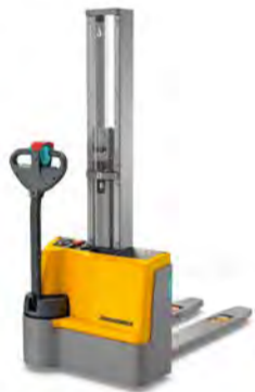
Elektromos gyalogkísérő targonca Típus EJC M10 E Max. emelési magasság 1900 mm Teherbírás max. 1000 kg
