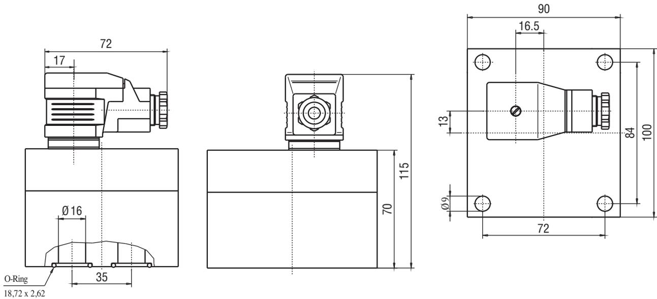
Durchflusswiderstand VCG 2 Parameter: Viskosität (mm<sup>2</sup>/s)
