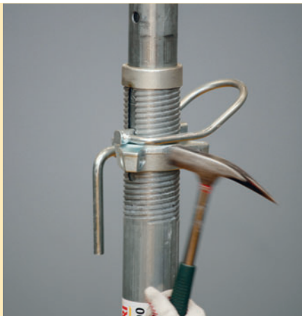
Az állítóanyán lévő kalapálható felületek kialakítása meghatározza az ütés irányát.
