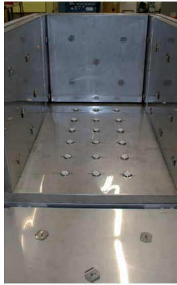
Előmelegítő és fűtőszekrény süllyesztékben kovácsolt darabok előmelegítéséhez és feszültség-mentesítő hőkezeléséhez.
