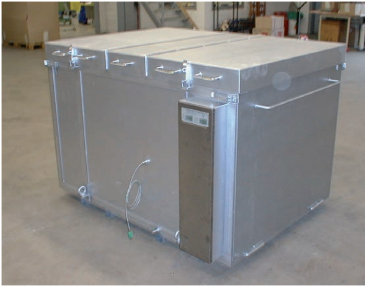
Előmelegítő és fűtőszekrény süllyesztékben kovácsolt darabok előmelegítéséhez és feszültség-mentesítő hőkezeléséhez.
