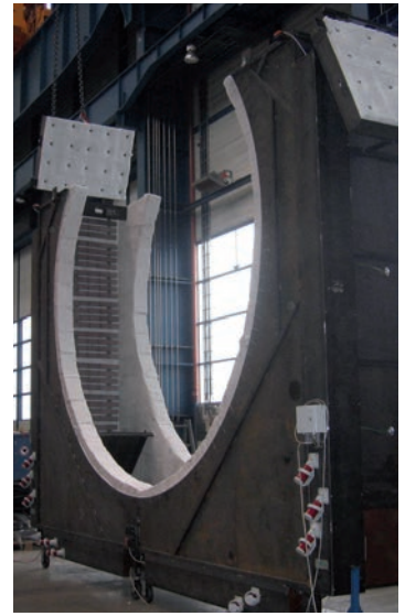
Kétrészes előmelegítési berendezés forgó nagy tartályokhoz
