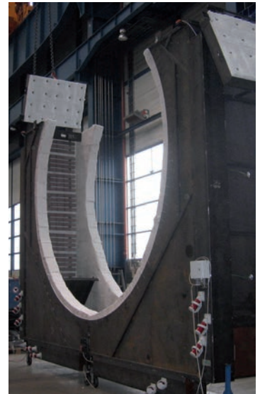
Kétrészes előmelegítési berendezés forgó nagy tartályokhoz
