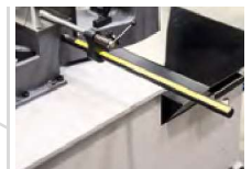
Möglicher Anschluss des Längenaufschlags
