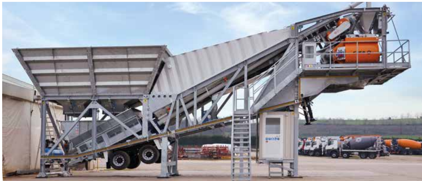
FIVETECH 1000W - Fully mobile plant during transportation (above) and in working position (below). The plant can be equipped with up to three vertical cement silos. Impianto mobile su ruote durante la fase di trasporto (sopra) ed in posizione di lavoro (sotto). L'impianto può essere equipaggiato con tre silos cemento verticali.
