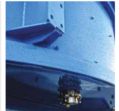
Concrete moisture probes installed in the mixer. Sonde per misurazione umidità del calcestruzzo nel mescolatore.
