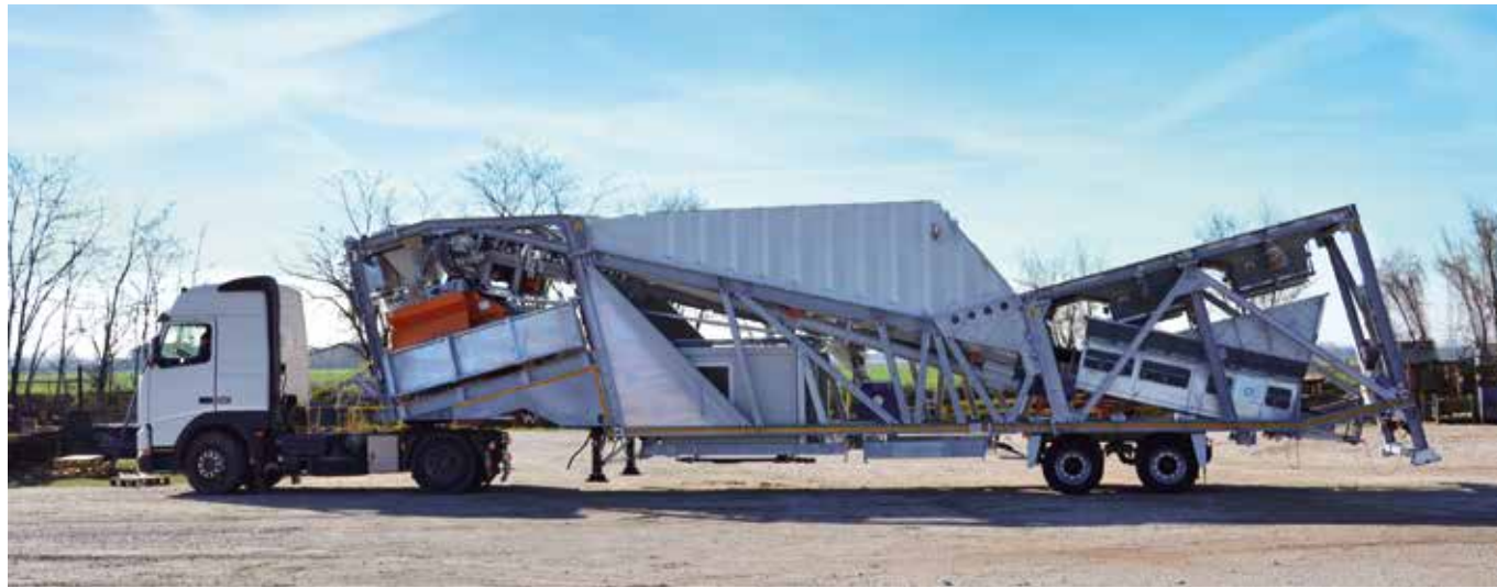
FIVETECH 1000W - Fully mobile plant during transportation (above) and in working position (below). The plant can be equipped with up to three vertical cement silos. Impianto mobile su ruote durante la fase di trasporto (sopra) ed in posizione di lavoro (sotto). L'impianto può essere equipaggiato con tre silos cemento verticali.
