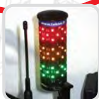
Audiovizuális figyelmeztető rendszer 90%-100% terhelési kapacitás elérésekor
