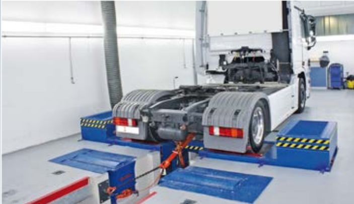
MAHA LKW Leistungsprüfstand „LPS 3000“ mit geteiltem Rollensatz für Grubeneinbau.
