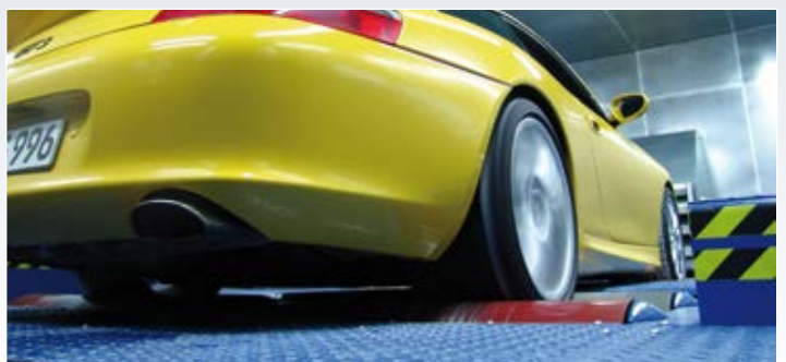
MAHA PKW Allrad-Leistungsprüfstand „LPS 3000“ mit Schallschutzkabine, Belüftungssystem inkl. Kühlgebläse und Absauganlage in kundenspezifischer Ausstattung.
