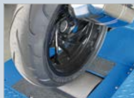
Scheitelrollensatz für einen optimalen Grip und geringe Reifenerwärmung.
