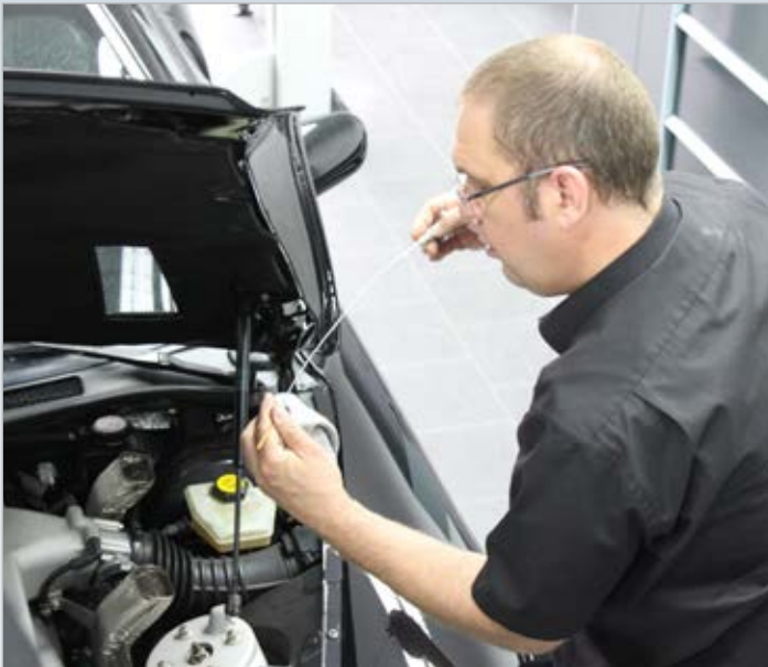
Überprüfung des Ölstandes und des Kühlwassers
