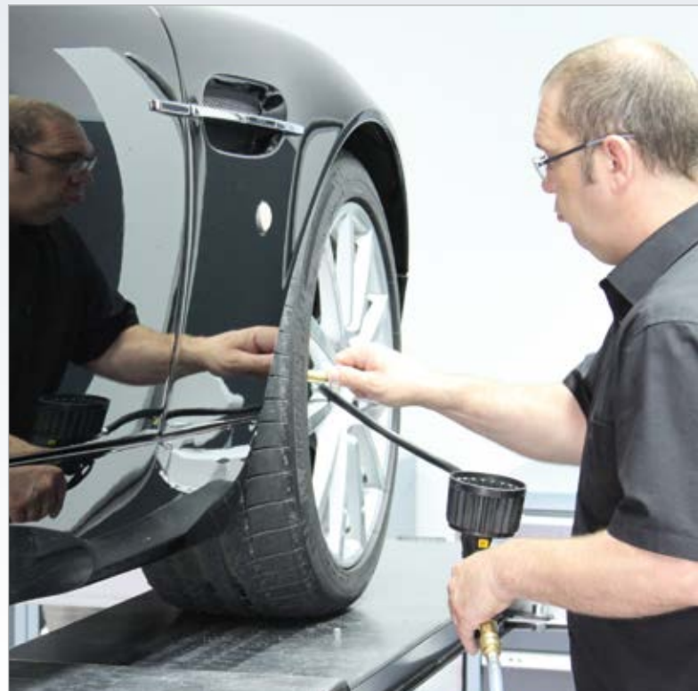
Überprüfung der Reifen nach Beschädigungen, Fremdkörpern im Profil und dem Geschwindigkeitsindex. Sitz der Radbolzen kontrollieren und Luftdruck messen.
