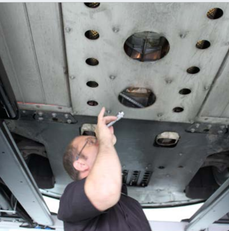
Allgemeine Sichtkontrolle und Festlegung der geeigneten Punkte für die Fahrzeugfixierung
