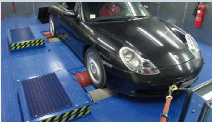
MAHA PKW Allrad-Leistungsprüfstand „LPS 3000“ mit Schallschutzkabine, Belüftungssystem inkl. Kühlgebläse und Absauganlage in kundenspezifischer Ausstattung.
