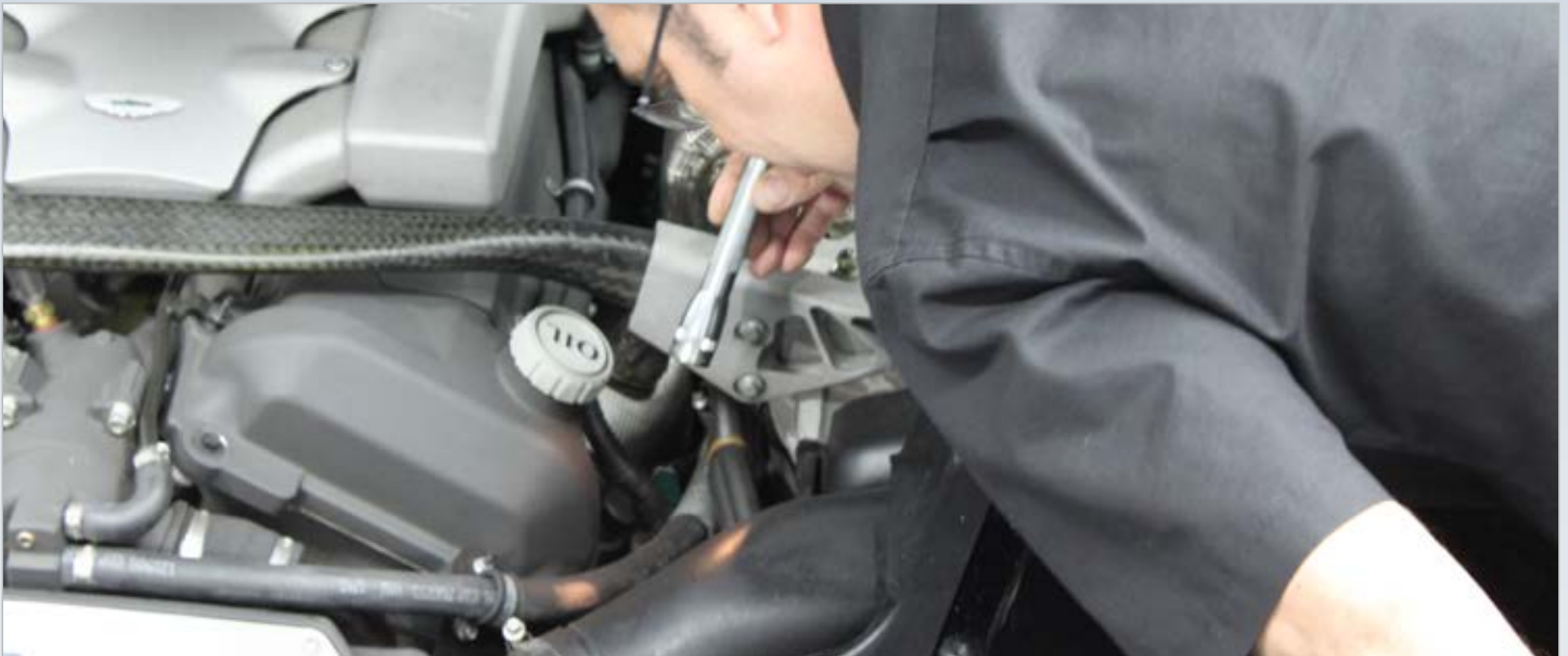
Sichtkontrolle der Öl, Wasser und vor allem Kraftstoffleitungen auf Dichtheit
