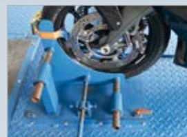
Klemmvorrichtung zur sicheren Fixierung des Vorderrades
