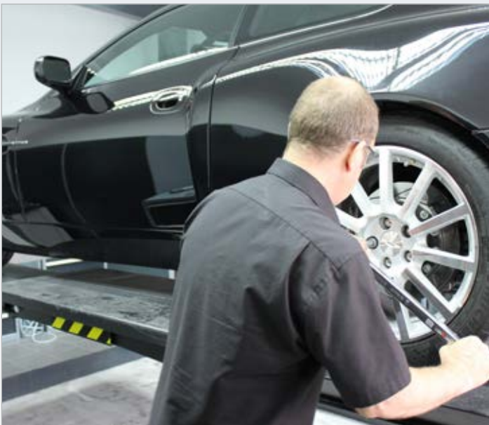
Überprüfung der Reifen nach Beschädigungen, Fremdkörpern im Profil und dem Geschwindigkeitsindex. Sitz der Radbolzen kontrollieren und Luftdruck messen.
