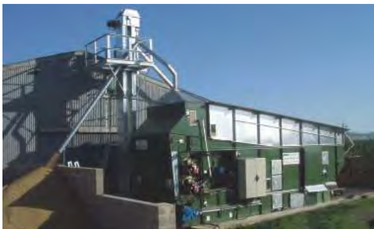
↑ Tipikus farmgazdasághoz méretezett szárítástechnika - DF 17750 szárító - 19,5 t/h
