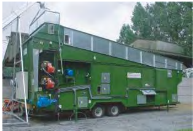
MDF 22000 típusú 25 t/h-s mobil szárító
