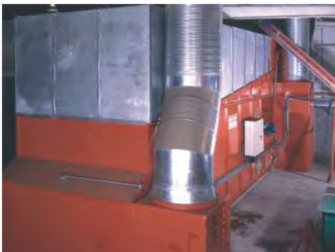
DF 22000 szárító - a gőzelvezetés szakszerű, nagyüzemi alkalmazása
