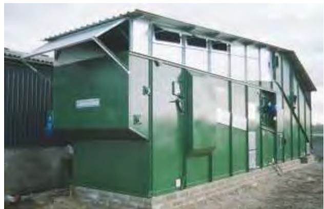
SP 13750 típusú szárító - a nem szemes termények szárítására kifejlesztve (faforgács, gyógynövények, stb.)
