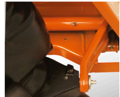
A 10/12 zsírzási pontnak köszönhetően az LHM230 típust hosszabb élettartam, mérsékelt kopás és hatékonyabb karbantarthatóság jellemzi
