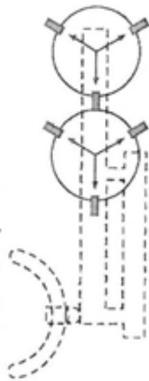
Rys. 15. Prawidłowy – przeciwny układ nożyków na bębnach roboczych kosiarki
