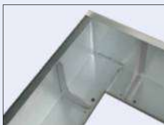
Sarokkialakítások egyszerűen, lemezollóval történő bevágással készíthető, hajlítható és bármilyen szögben kialakítható.
