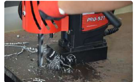
Akár 23mm-es fúrási teljesítmény • Max. löket hosszúság 190mm
