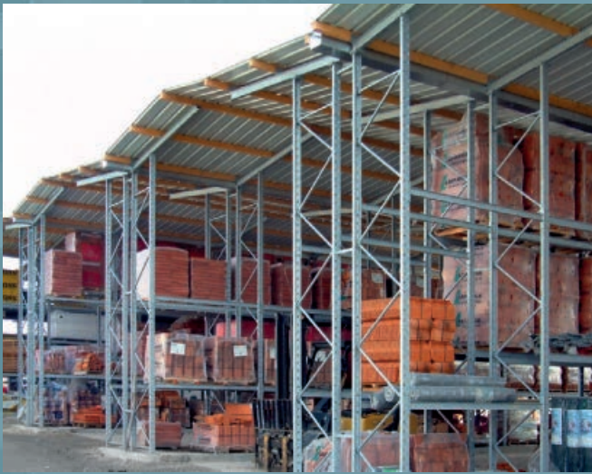
Nyitott raklappolc csarnok építőanyagok tárolásához. Kétoldalú polc, teljesen horganyzott kivitelben, blokkalapra szerelve.
