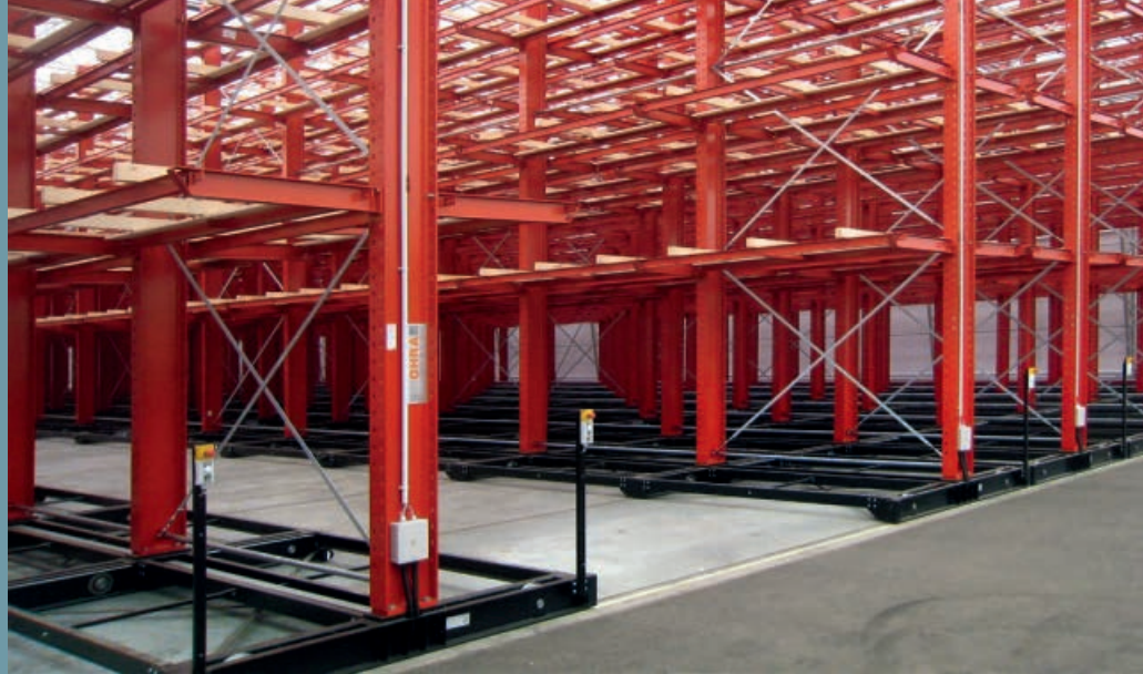
Üres mozgatóberendezés. Gombnyomásos, elektronikus vezérlés minden egyes mozgató kocsihoz.
