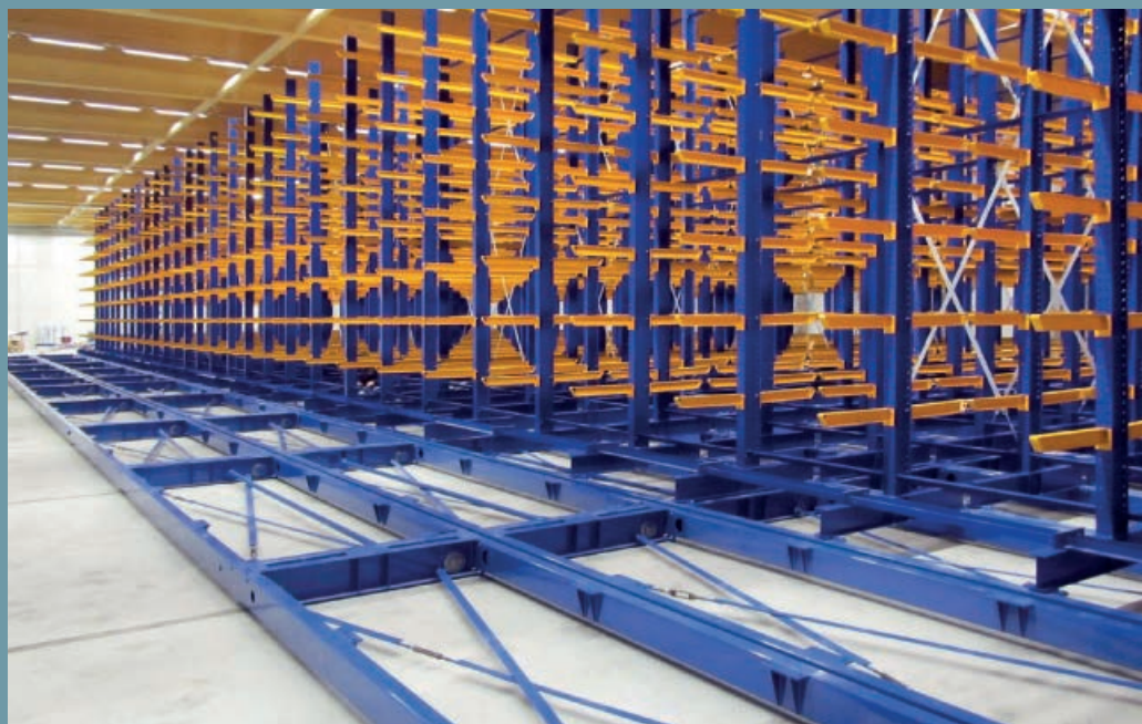
A mozgatóberendezések különösen a különböző alumíniumprofilok raktározásának céljára képeznek optimális tárolórendszert.
