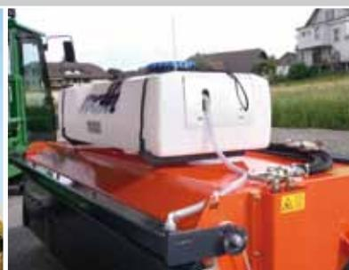
Wassersprüheinrichtung mit 100/200 Liter Wassertank
