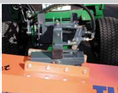
doppelter Niveaueingleich mit hydraulischer Seitenverstellung
