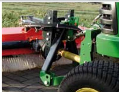
mechanischer Antrieb für Drehzahlen von 540 bis 2100 /min
