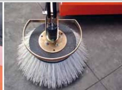
Seitenkehrbesen hydraulisch angetrieben
