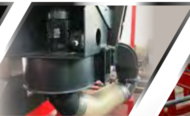
Kiegészítő fűrészpor-elszívó rendszer ventilátorral a gépen.
