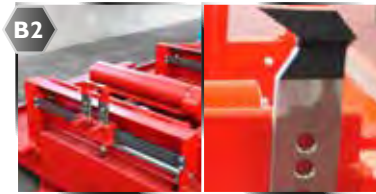
markolat két hengerrel + mechanikus markolat emelése
