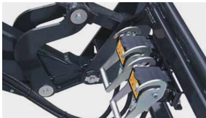
Fix munkaeszköz 2 utas csatlakozó a 3. és 4. hidraulikakörhöz.
