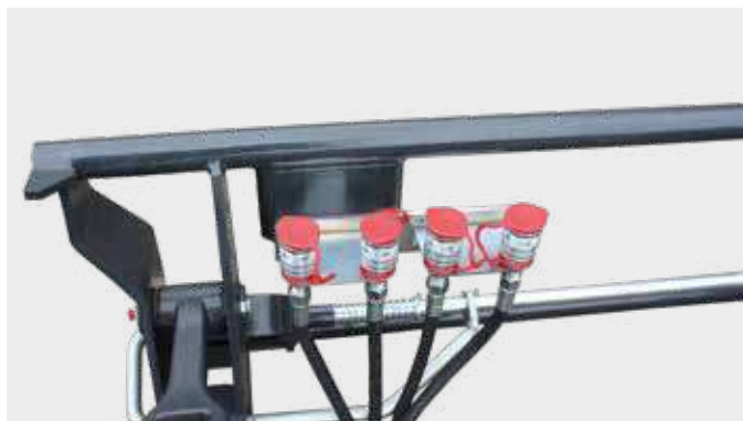
3. és 4. hidraulikakör (itt mint dugós csatlakozó) A hidraulikus munkaeszközök egyszerű kezeléséhez, mint amilyen a szilázsfo- gó, bálamegfogó vagy bálaszállító targonca.
