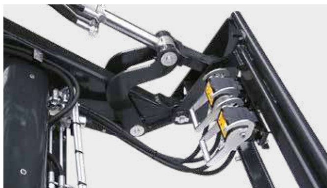
A hidraulikavezetékek még gyorsabb csatlakoztatása érdekében az eszközfelfogatást is ellátták Hydro-Fix rendszerrel.
