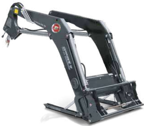
FS gémszerkezet párhuzamvezetés nélkül: Nehéz körülmények között végzett munkához, kiváló ár-érték arány mellett
