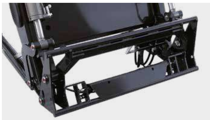
Gombnyomásra működő munkaeszköz-rögzítő mechanizmus, még kényelmesebb eszközcsere, leszállás nélkül – a HYDRO-LOCK-al.
