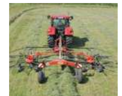
Az Andex több rotoros rendképzők fel vannak szerelve TerraLink Quattroval a kiváló rendképzés érdekében. Az Andex 644 kivétel.
