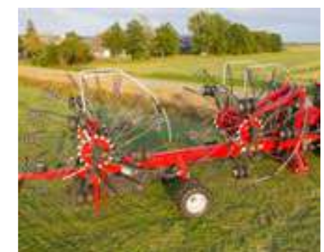
Az okos csukási mechanizmusnak köszönhetően a teljes magasság 4.00m alatt marad a rotorok 3.85m átmérője ellenére.
