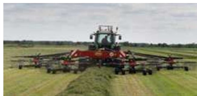
A munkaszélesség 10-12.5m között hidraulikusan állítható. A rendszélesség 1.2 és 2.2m között szintén hidraulikus állítású.
