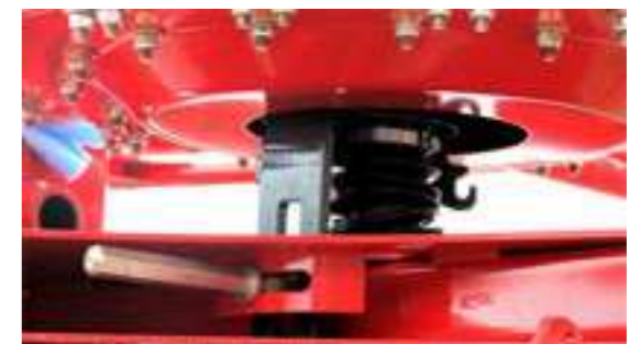
Vicon Andex 1104 ProLine állítható vezérlőpálya.
