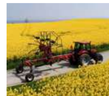
A Vicon közép rendképzőket hidraulikusan állítjuk munka helyzetből szállítási helyzetbe.
