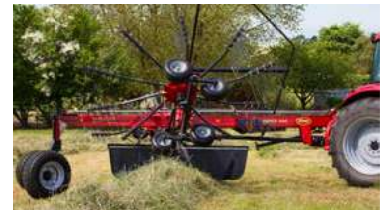
A rotortartó kiemelési magassága, elég helyet biztosít a fordulóban.
