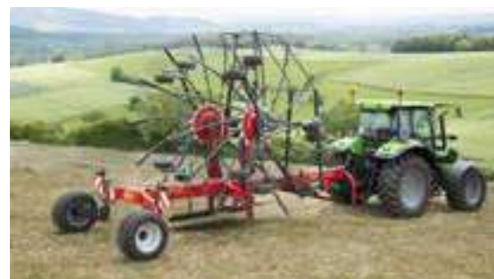
Vicon Andex 1254 Hidraulikusan leengedhető, magasság 4 m alatt.
