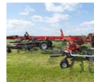
Minden rotor magassága függetlenül és hidraulikusan állítható. Továbbá a minimális magasság mechanikusan meghatározható a pontos beállítás biztosítására.
