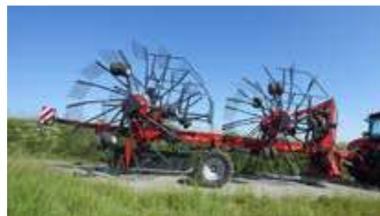
Vicon Andex 1505 Okosan összecsuksukható mechanizmus közúti szállításhoz.
