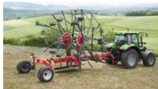
Vicon Andex 1254 Hidraulikusan leengedhető, magasság 4 m alatt.
