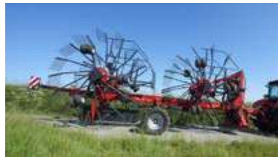
Vicon Andex 1505 Okosan összecsukszó mechanizmus közúti szállításhoz.
