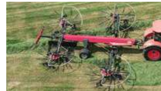
Vicon Andex 1304 Pro Mind a négy rotor egyenként mozgatható.
