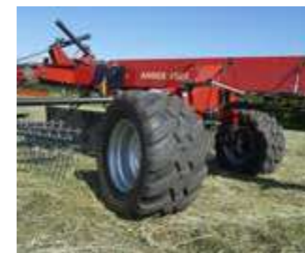
Az opcionális aktív kerékkormányzás kiváló manőverező képességet biztosít szűk átjárókban, sarkokban.
