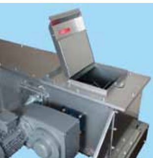
Torlódásgátló ajtó/ szerelőnyílás biztonsági kapcsolóval.
