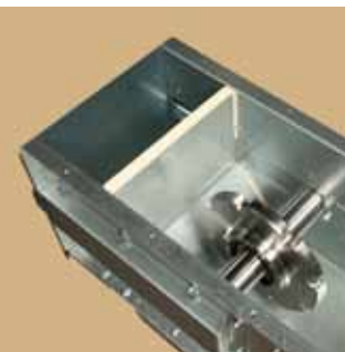
Változtatható homloklap a különleges tisztaság érdekében.
