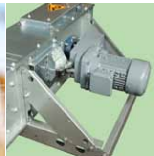
Közvetlen ráépítésű hajtómű motor tartóval.
