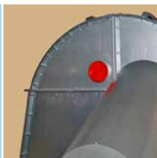
Felvonó védőburkolat aspiráció csatlakozással.
