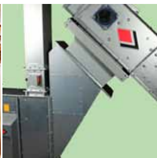
Csatlakozó garat a láncos szállító és a felvonó közt.
